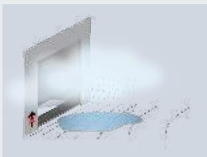
Der Laserscanner öffnet zuverlässig und sicher auch bei reflektierenden Flächen, widrigen Wetterbedingungen, Laub oder Schnee.
