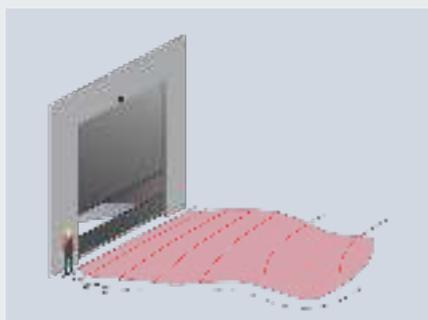
Das Erfassungsfeld kann frei an die Bedingungen vor Ort angepasst werden. Querverkehr oder rangierende Objekte können auf diese Weise ausgeblendet werden.
