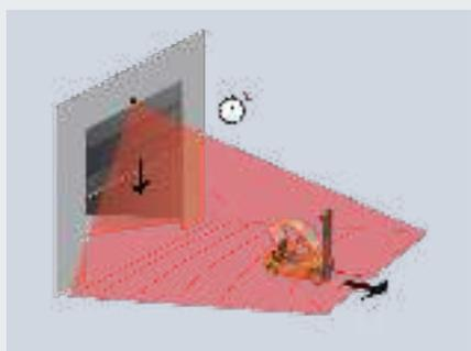
Das Laserfeld dient als zuverlässiger Torwächter. Es erkennt die Richtung und Geschwindigkeit, die ein Objekt fährt und sorgt so für optimale Reaktionszeiten beim Öffnen und Schließen. Die Haltezeit des Tores kann so minimiert und Energie eingespart werden.
